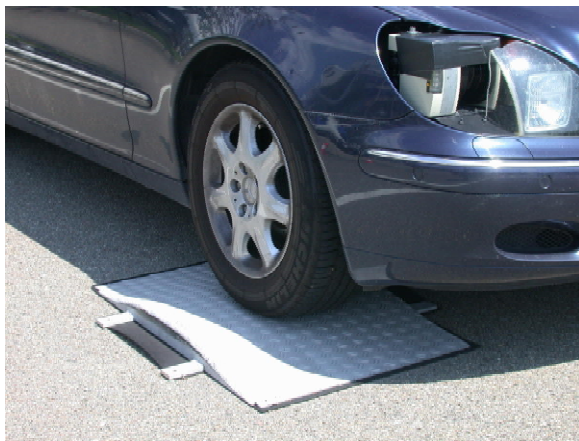
Bild 14: Überfahrt der PRE-SCAN-Schwelle.
