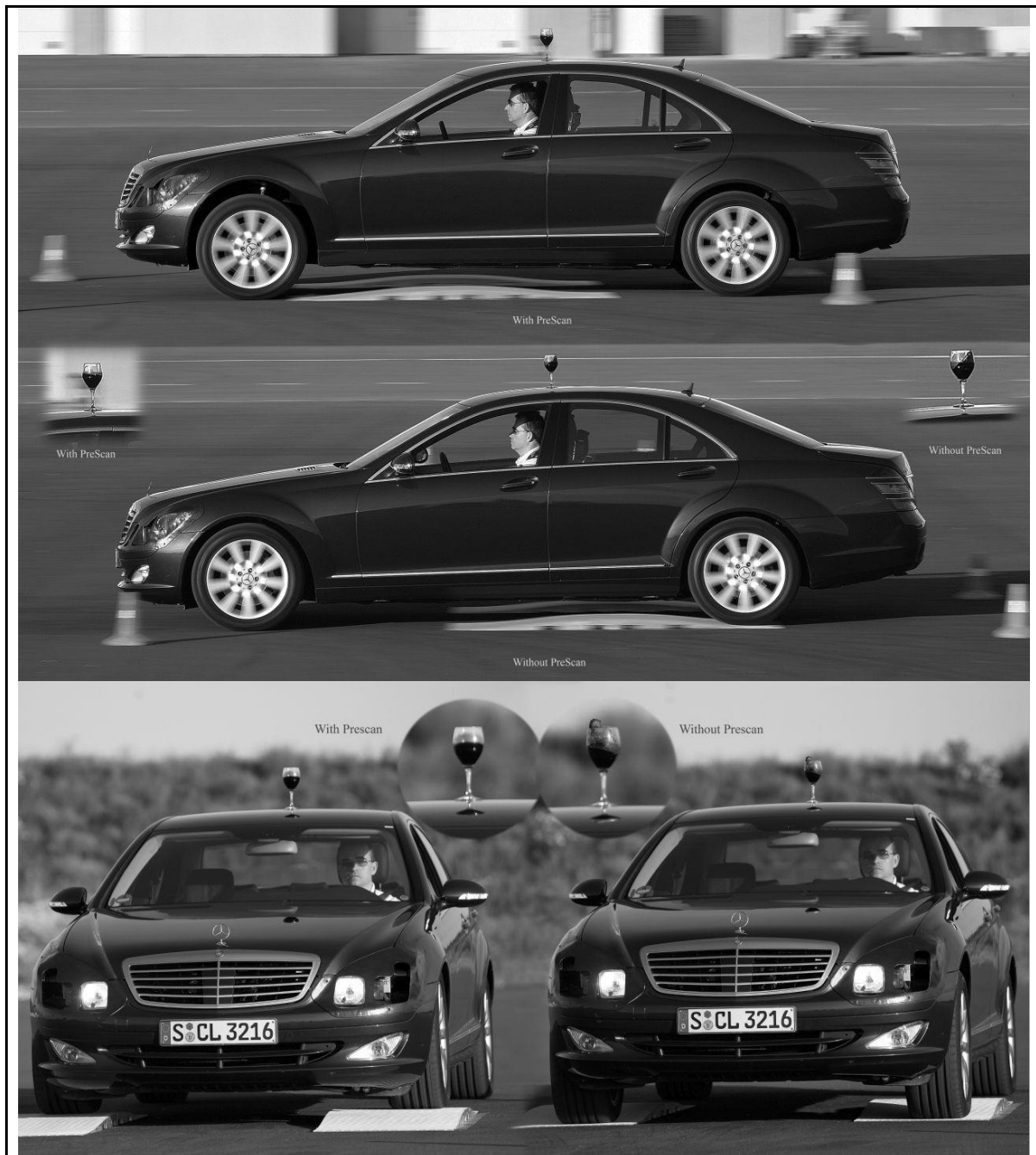
Bild 20/21: PRE-SCAN und das Weinglas: Mit 20 km/h wird nichts verschüttet. Ohne PRE-SCAN leert sich das Glas.
