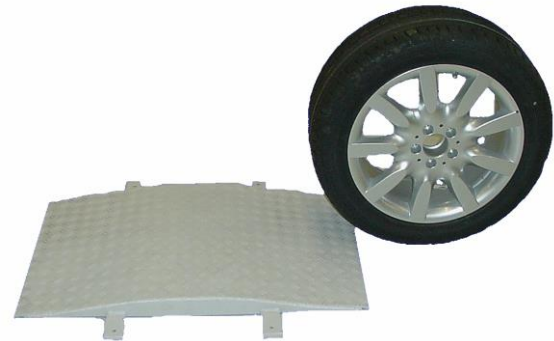
Bild 15: Die PRE-SCAN-Schwelle ist eine 5 cm hohe und 1 m lange sinusähnliche Bodenwelle.
