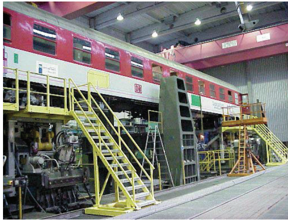
Bild 6.1: Modellgestützte Querkomfortregelung für Hochgeschwindigkeitszüge auf dem Prüfstand in München [ROLLP85]
